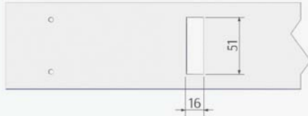
FPD4 için dikme kanalı Rectangular hole for FPD4 Post
